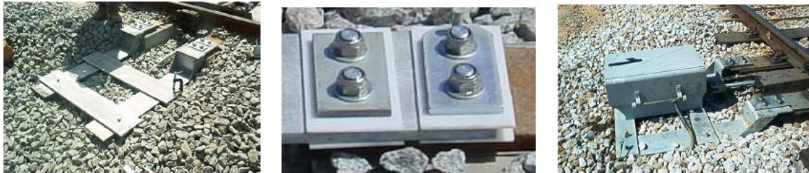
Figura 19. Detalle de la colocación del motor de aguja MD2000 y de la base de sujeción
