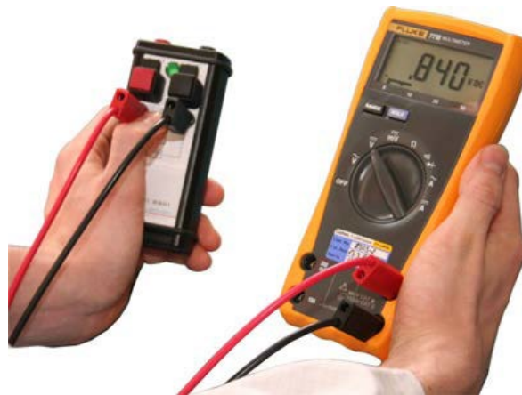
Figura 17. Conexión para puesta en servicio
